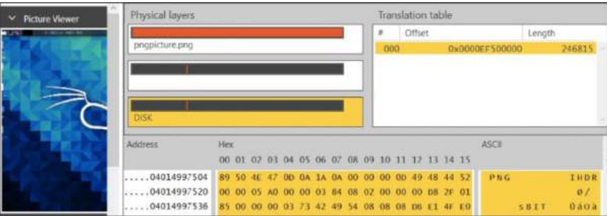
Fig. 3.27: MSAB’s XAMN Source Mode showing the PNG File Header (Hex): 89 50 4E 47 0D 0A 1A 0A
