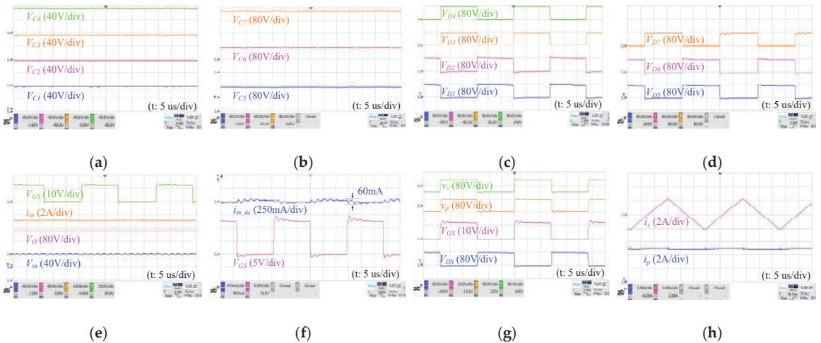
**Figure 11.** Experimental waveforms of the prototype: (a)  $V_{C1}$ ,  $V_{C2}$ ,  $V_{C3}$ , and  $V_{C4}$ ; (b)  $V_{C5}$ ,  $V_{C6}$ , and  $V_{C7}$ ; (c)  $V_{D1}$ ,  $V_{D2}$ ,  $V_{D3}$ , and  $V_{D4}$ ; (d)  $V_{D5}$ ,  $V_{D6}$ , and  $V_{D7}$ ; (e)  $V_{in}$ ,  $V_O$ ,  $i_{in}$ , and  $V_{GS}$ ; (f)  $i_{in-ac}$ , and  $V_{GS}$ ; (g)  $V_s$ ,  $V_{GS}$ ,  $v_p$ , and  $v_s$ ; (h)  $i_p$  and  $i_s$ .
